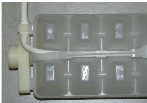
4. Brancher le bac sur le moteur et clipser le câble de la sonde au niveau du moteur. La longueur du câble est de 10,5 cm. comme indiqué ci-dessous.
