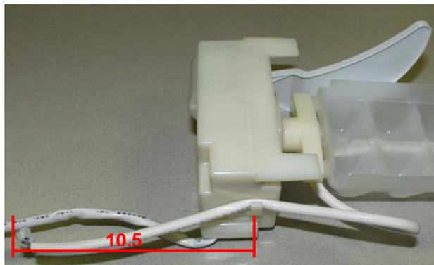
5. Placer le bac et le moteur dans le nouveau boîtier et le fixer avec la vis.
