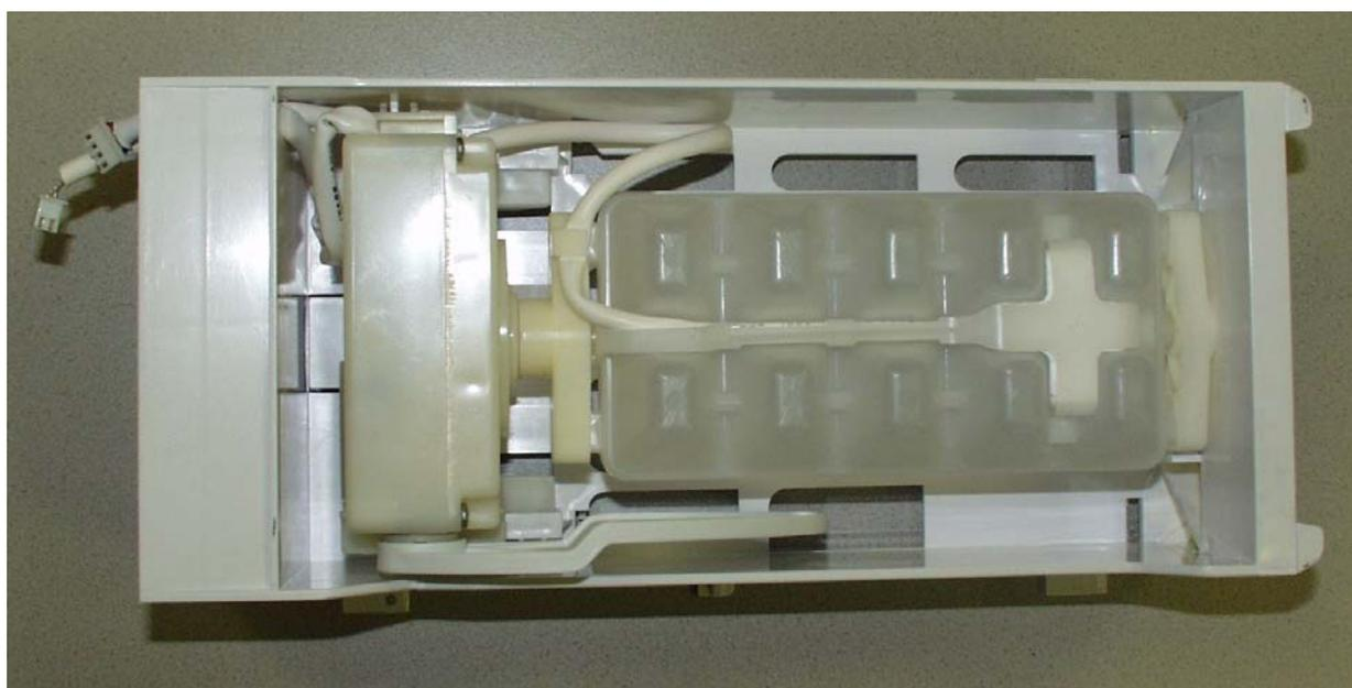
6. Mettre la platine et brancher les câbles. Mettre la couverture et remettre la fabrique en place
