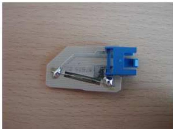
Version AWECO équipé d'un connecteur bleu
