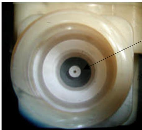
Le disque en caoutchouc doit être visible de l'extérieur
